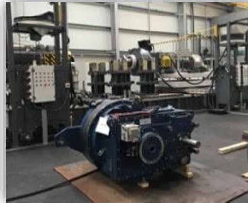
Banco de ensaios para Multiplicadoras até 2,5 MW
