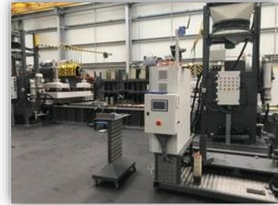
Banco de ensaios para Multiplicadoras até 2,5 MW
